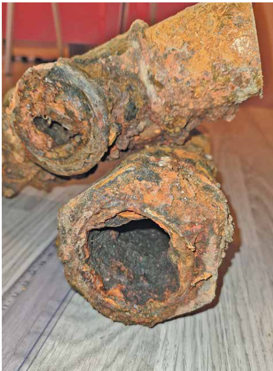
LEKKER: Harstad kommune har brukt store beløp på vannrensning, men i sprede-nettet i boligfeltene lekker det ut i gamle og rustne rør. Foto: Brødrene Killi AS
