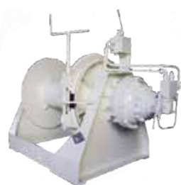
Ankervinsjer i aluminium Typesertifiserte i DNV frå 12,5, K2 til 32 K2. Kan leveres med bremsekraft opp til 120 Tonn.
