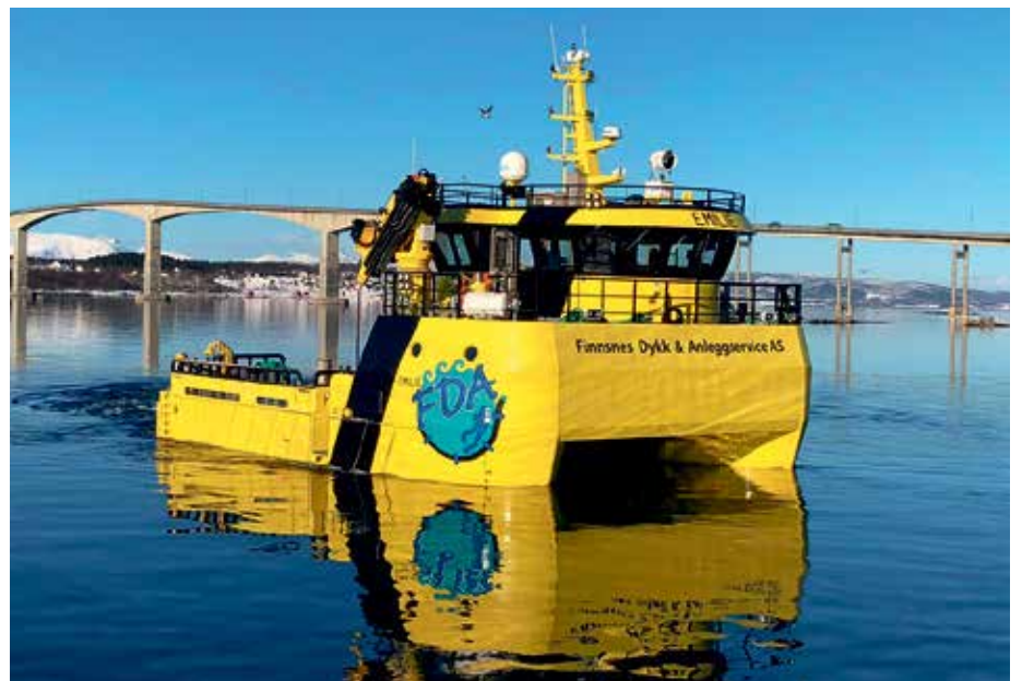
En rekke av fartøyene til Finnsnes Dykk & Anleggsservice er katamaraner. Det gjør dem mer stabile i ulendt farvann. Foto: Finnsnes Dykk og Anleggsservice AS
