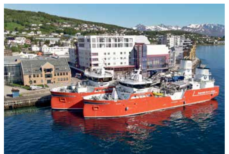
Nybåten "Skrova" og "Grotanger" til kai i Harstad. Den 64 meter lange "Skrova" har en laste-kapasitet på 1.200 kubikkmeter. Det gir en kapasitet til å føre 200 tonn levende fisk. Foto: Brønnbåt Nord AS
